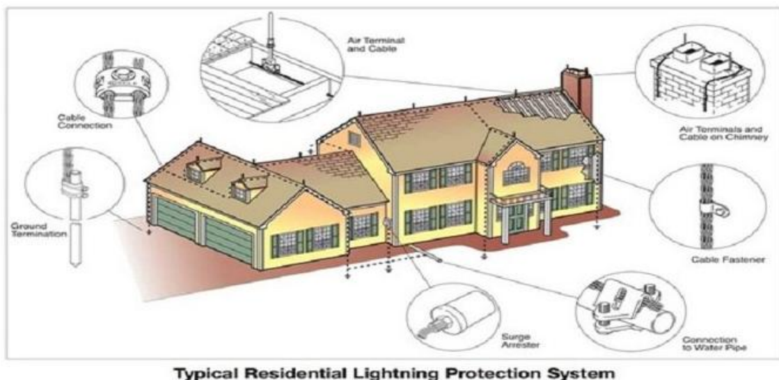
Gambar ilustrasi penangkal petir di suatu bangunan
