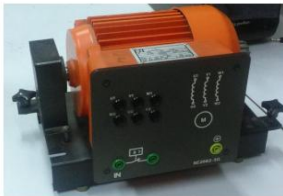
Gambar 22. Motor 3 Phase (Kardiaman, 2015)
