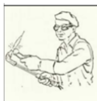
Gambar 9. Penyalakan yang salah
