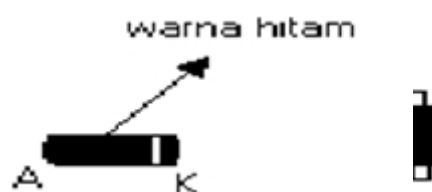
Gambar 33. Bentuk Fisik Dioda pada PCB Telepon Seluler
