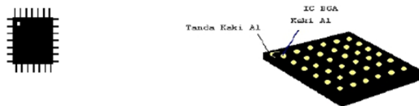
Gambar 37. Simbol dan Bentuk IC BGA
