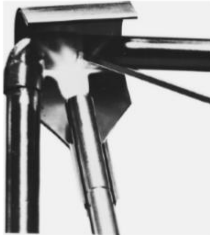
Gambar 21 Sebuah perisai digunakan ketika mematri atau solder. Courtesy of Thermadyne Industries, Inc
