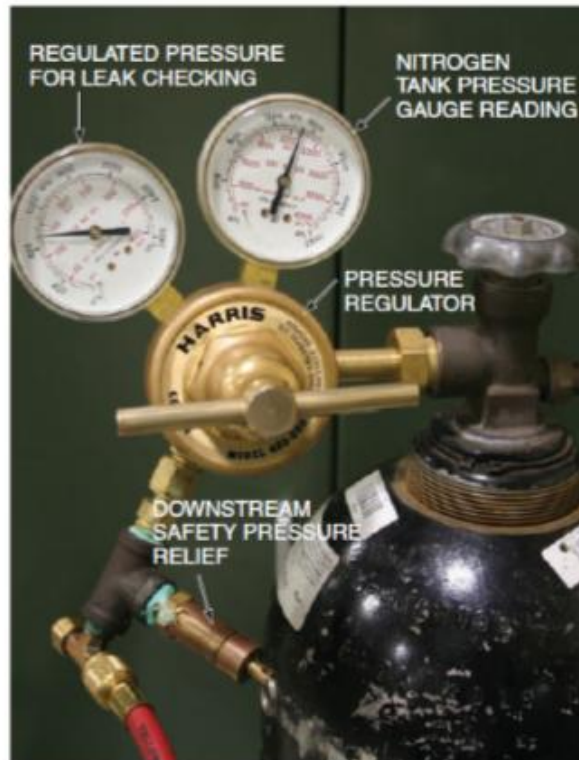
Gambar 9 silinder nitrogen dengan regulator tekanan dan safety downstream katup pelepas tekanan (pressure relief valve).
