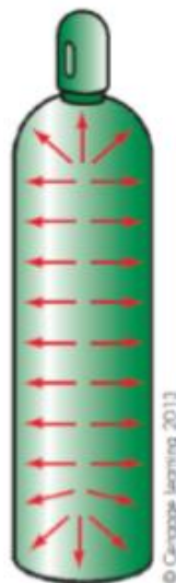
Gambar 1. Tekanan yang diberikan di seluruh permukaan dari silinder pendingin
