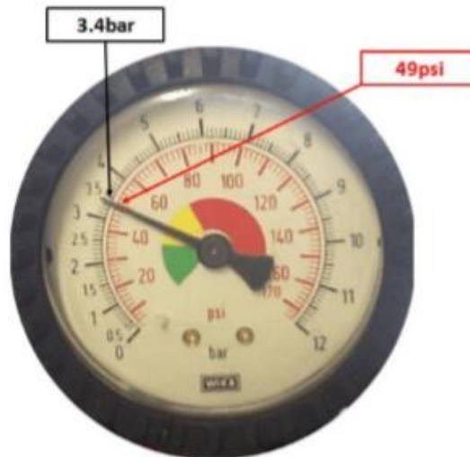
Gambar 14 . Penunjukan jarum pada satuan psi dan bar
