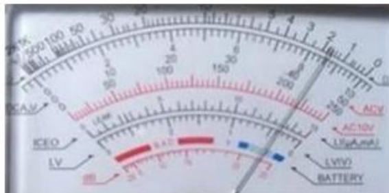
Gambar 12 . Petunjuk Jarum pada Skala Meter Pengukuran Tegangan AC PLN
