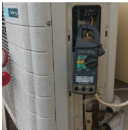
Gambar 15 . Pengukuran Arus menggunakan Tang Ampere
