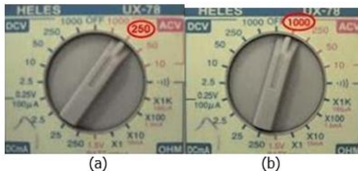
Gambar 10 . (a) Batas Ukur 250 ACV dan (b) Batas Ukur 1000 ACV
